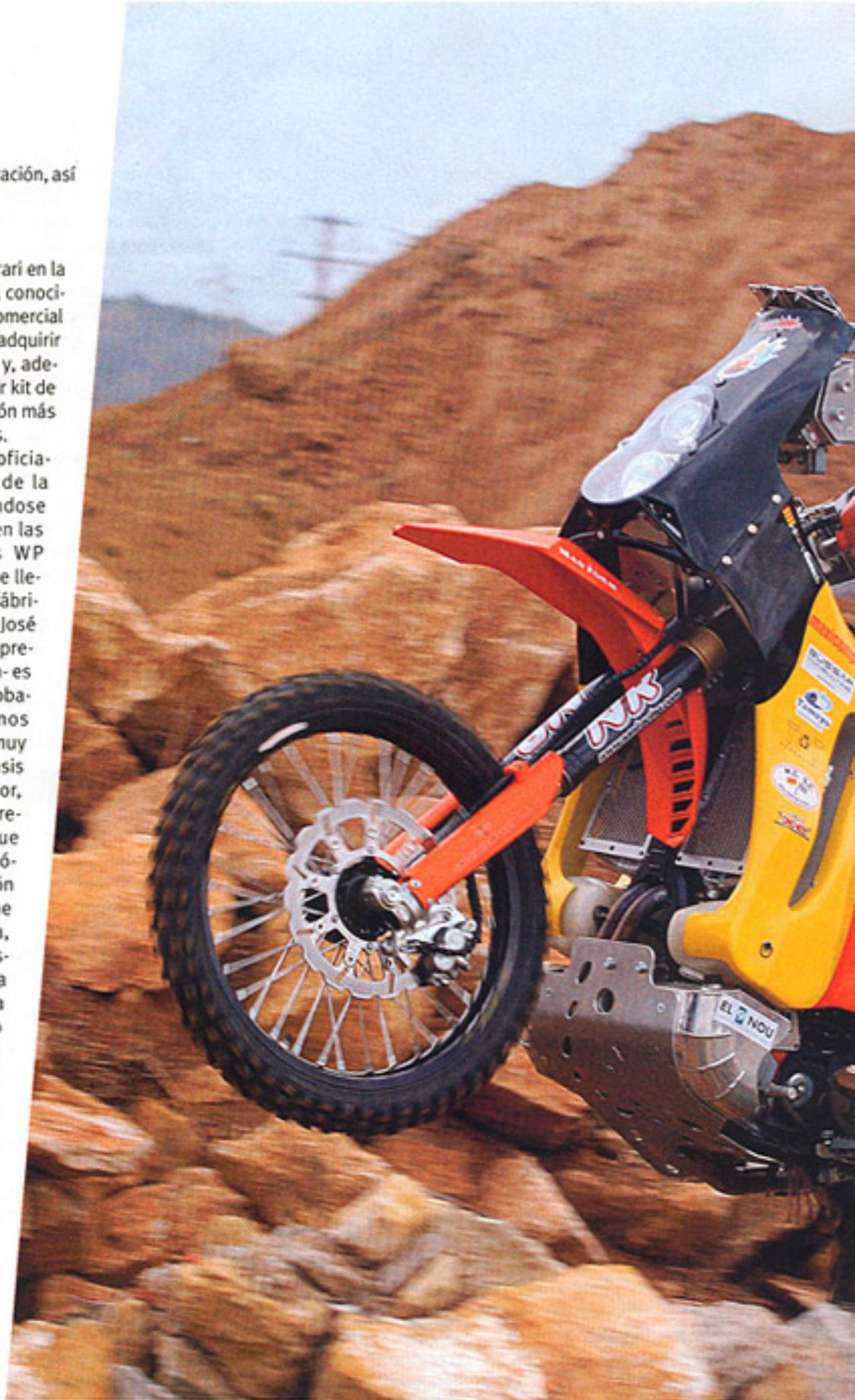
**ADAPTADA.** Tomando una KTM 525 y acoplándole el kit de raids que vende Mecasystem tendréis la moto lista. La lista de piezas incluye depósitos, delanteros y traseros; escape, carrocería... Hay otras piezas como la suspensión WP, los estribos, el disco delantero que se han montado al gusto del piloto.
